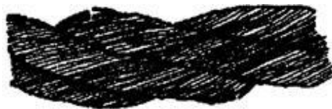
Рисунок 1. Обрывы и смещения проволок каната крестовой свивки.
