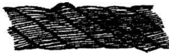
Рисунок 1. Обрывы и смещения проволок каната крестовой свивки.
